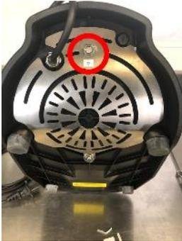
Fig. 17 : Connexion au conducteur d'équipotentialité
